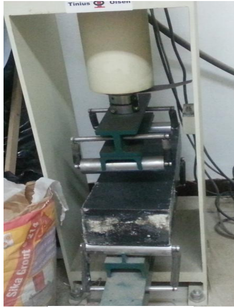
Fig.8. Actual flexural test
