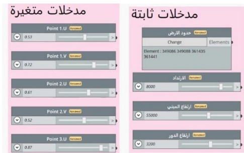
شكل (١٤) مرحلة إدخال البيانات التي توضح محددات ومتغيرات التصميم. (الباحثون بواسطة دينامو)
