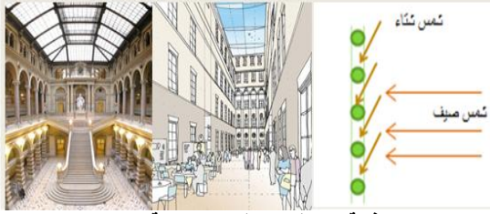
شكل (75) الافنية المغطاه بتغطيات زجاجية تغلق اوتوماتيكيا على حسب الاحتياج للهواء داخل الفراغ
