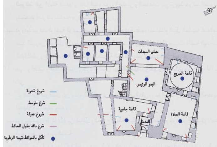
شكل رقم (3) توضح المسقط الأفقي للدور الأول لمدرسة وتوقع مظاهر التدهور عليه المصدر: تكنولوجيا الترميم الحديثة آلية لاستمرار حياة المباني التراثية، ص 211
