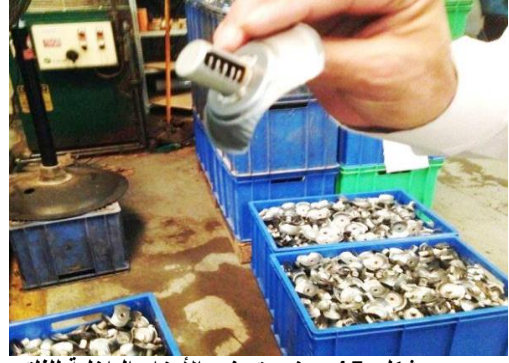
شكل: 15 يوضح تصنيع الأجزاء الداخلية للفلتر
