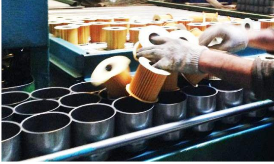
شكل: 16 يوضح تركيب الأجزاء الداخلية للفلتر
