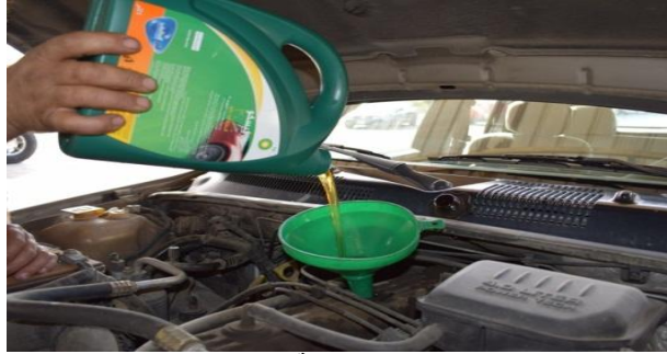
شكل:9 يوضح عملية تغيير الزيت
