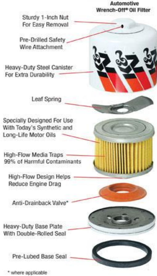
شكل: 2 يوضح مكونات الفلتر المستخدم
