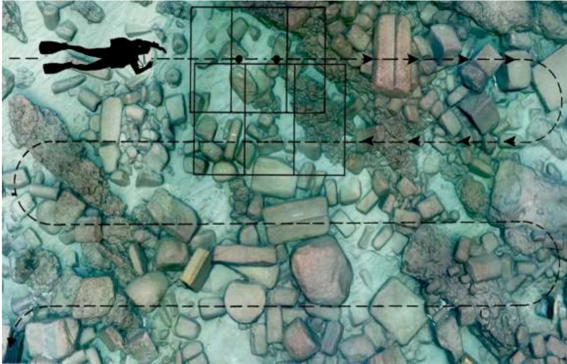
(شكل ١١) طرق التصوير المساحي التحتمائي توضح التداخل بين الصور في الذهاب والعودة، ونرى بالصورة التباين في
