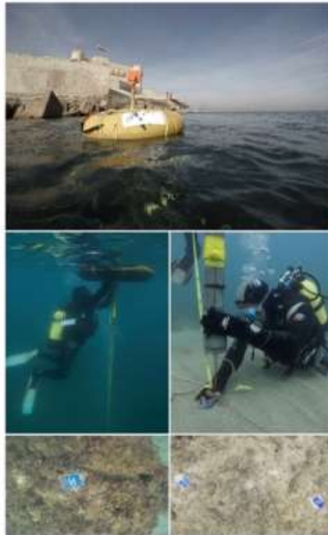
(شكل ٢٠) عوامة تطفو فوق سطح البحر مثبت فيها مرآة عاكسة (الخاصة لجهاز التوتال ستيشن Total Station) على عمود حديدي مربوط من أسفله بحبل يتصل فى نهايته فى القاع بأوزان من الرصاص تصل الى عشرون كجم، وذلك للرفع المساحى للأحداثيات
