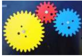
شكل (٤) يوضح الاحتكاك المباشر لنقل الحركة
