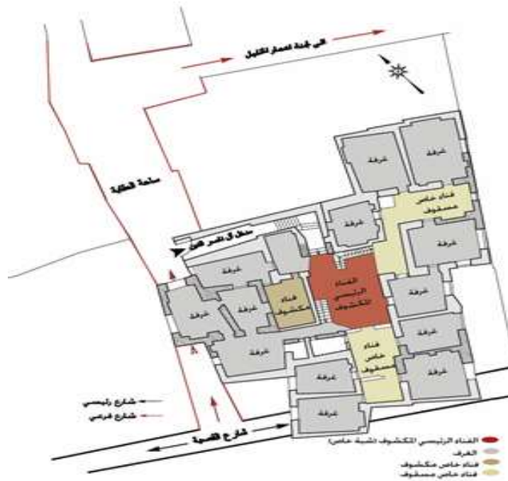
شكل "٤": علاقة مسكن آل ناصر الدين بالطريق العام وكيفية الانتقال من العام الى الخاص واستخدام الأفنية بالبلدة القديمة في الخليل ( المصدر: أبو سالم ، و دنديس، " المباني السكنية في مدينة الخليل القديمة"، ٣٤)
