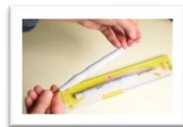
شكل (٦) امرار الخيط في تجويف الإبرة عن طريق اللضامة
