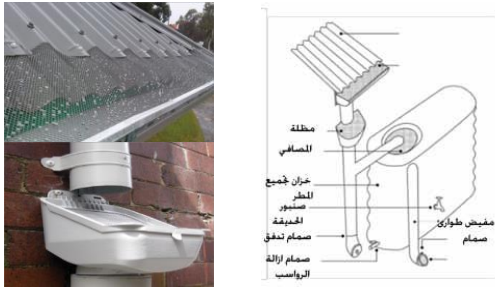
شكل رقم (٢): نظام لتجميع مياه الأمطار بواسطة المصمم المعماري [25]
