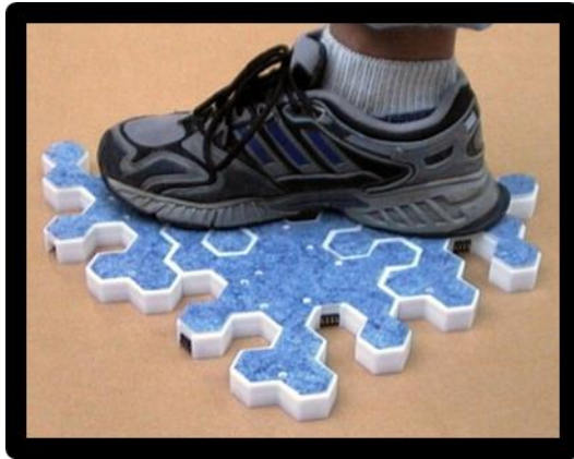
صورة (١٧) يوضح نظام أستخدمت فيه شبكة التركيب واللعب Net Workable plug&play للبلاط المسمى Z-Tiles حيث نجد كل منها يحتوي على حوالي اثني عشر مستشعر ضغط صغير متصل بجهاز كمبيوتر مدمج وسلسلة من البلاطات المتشابكة ومجهزة بالمعالجات المدمجة وهي عبارة عن سلسلة من أسلاك كهروضغطية في الاتجاه السين والصاد ، وتستخدم لإستشعار ديناميكيات موطئ الأقدام عند الضغط والحركة
