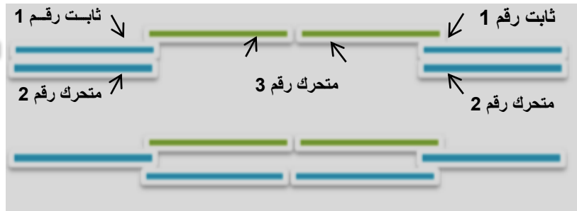
صورة (12) التقنية المستخدمة في تحريك القواطع ، حالة استخدام دلفة زجاج ثابت و اثنين متحركين داخل إطار معدني يتحرك علي 2 مجري. [مرجع 6]
