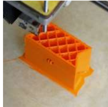
(شكل رقم 11) يظهر من الشكل كيف تستطيع ماكينة الطباعة ثلاثية الابعاد ان تنتج منتج فراغي مجوف مع الاحتفاظ بالمتانة المطلوبة
