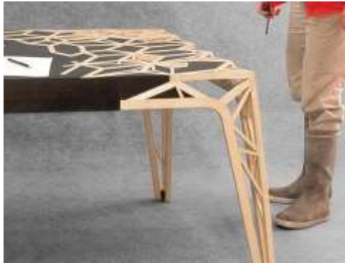
(شكل رقم 10) يظهر من الشكل كيف نجحت تقنية الطباعة ثلاثية الابعاد في انتاج مكونات المنضدة من خامات متعددة و تركيبها معا بكل دقة و تطابق .
