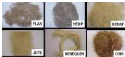
الخامات الطبيعية الداخلة في خلطات الخرسانة
