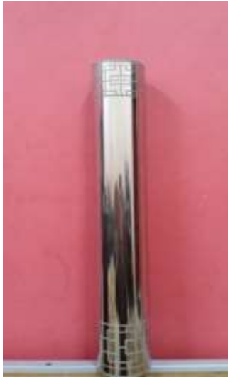
شكل ( 10 ) العينة بعد انتهاء عملية الحفر الكهروكيميائي
