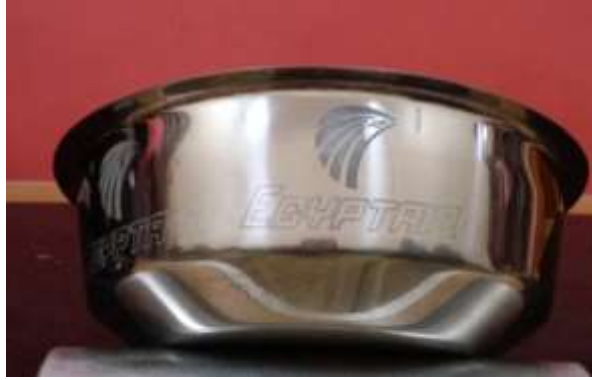
شكل ( 14 ) العينة بعد انتهاء عملية الحفر الكهروكيميائي
