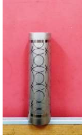
شكل ( 10 ) العينة بعد انتهاء عملية الحفر الكهروكيميائي
