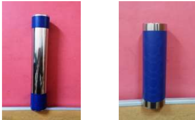
شكل ( 8 ) العينة بعد تغطية مساحات العمل تماماً بالمادة العازلة
