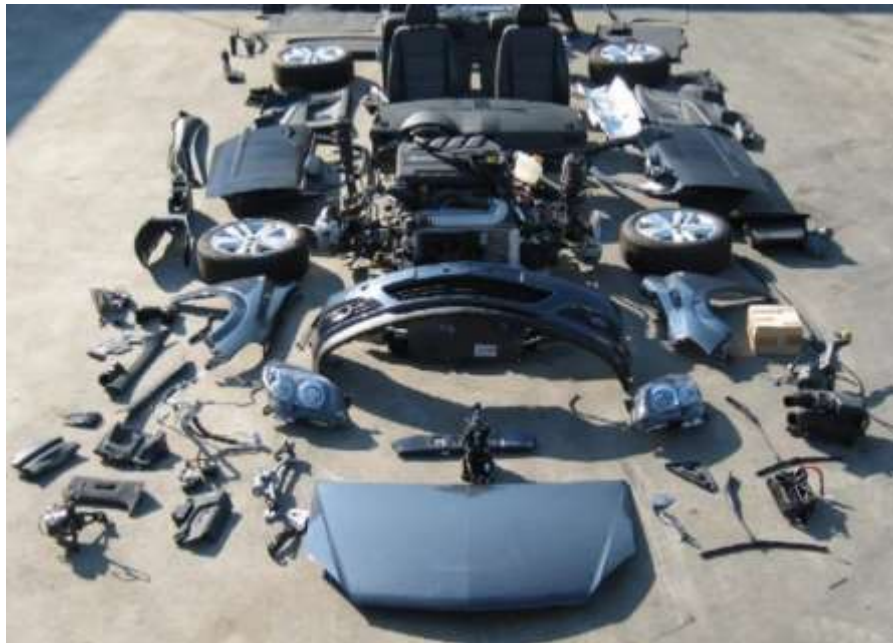
شكل (23): تفكيك المنتج (السيارة) كلياً للمواد الداخلة في صناعته وفصلها عن بعضها البعض لإعادة تصنيعها
