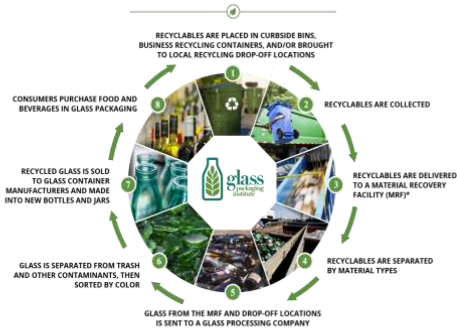
شكل (37): مراحل وخطوات إعادة تدوير وتصنيع الزجاج
