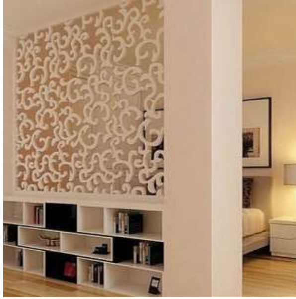
شكل (24) معلقة وظيفية قاطوع رأسي في الحيز الفراغي المقترح ، أخشاب مصنعة مفرغة وبطلاء أبيض بوليمري.
