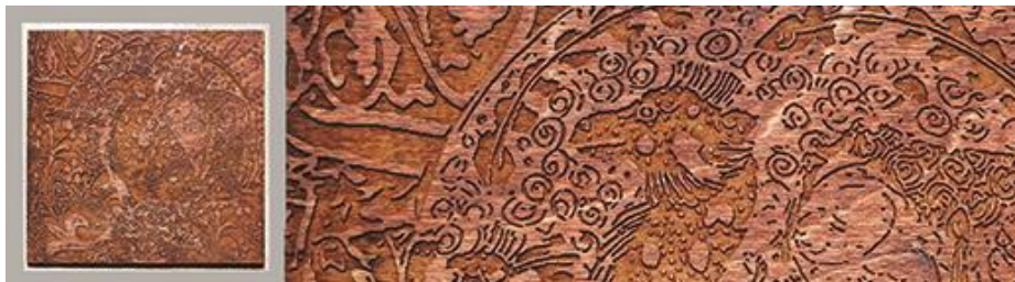
شكل(14) تأثير سرعة و قوة شعاع الليزر فى التحكم فى عمق الحفر على خامه الخشب.
