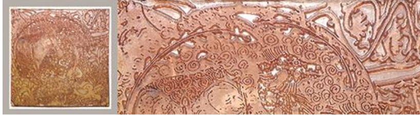
شكل(16) تأثير سرعة و قوة شعاع الليزر في التحكم في عمق الحفر على خامة السيريل سمك 5مم.
