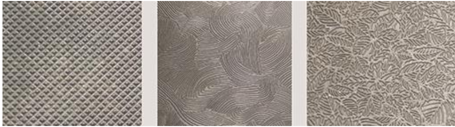
شكل(11) امثله لبعض التأثيرات الملمسية الدقيقة المحفوره بالليزر على القوالب الطباعية.
