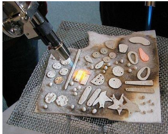
شكل رقم (15) الحرق بإستخدام اللهب المباشر أو البورى
