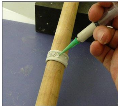
شكل رقم (10) تشكيل العجينة بالبتق (1)
