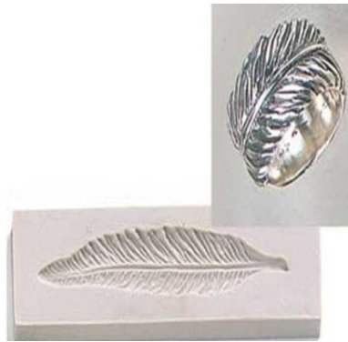
شكل رقم (9) تشكيل العجينة داخل القوالب
