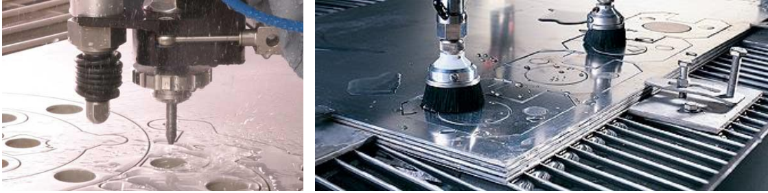
شكل رقم ( 8 ) يوضح ألواح معدنية معالجة عن طريق CNC
