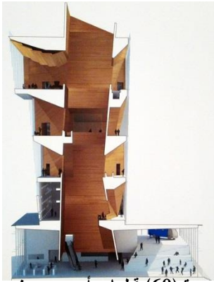
صورة (60) قطاع رأسى عرضى يوضح الفكر المبتكر لفناء ينتهى بملقف هواء بعمل ميول موجه ناحية الرياح لخلق تفق هوائى
