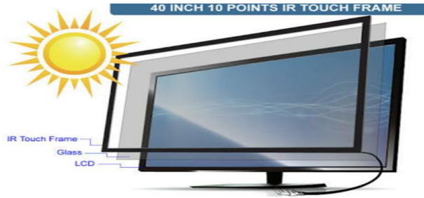
شكل توضيحي لكيفية عمل الرقائق التفاعلية، حيث يوضع إطار لشاشة تعمل باللمس وخلفه طبقة زجاجية ومن خلفها شاشة LCD
