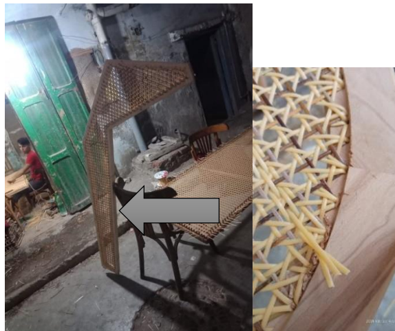
شكل رقم (11) توضح لنماذج لتركيبة حشوات الكانيه بمصر؛ تصوير الباحث.
