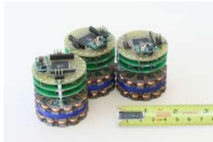
شكل(3) يوضح نموذج Catom بقطر 44 مليمتر (Kirby, B., etal. (2005).
