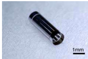
شكل(4) يوضح نموذج Catom بقطر (1) مليمتر (Mustafa E. K., etal.2009)
