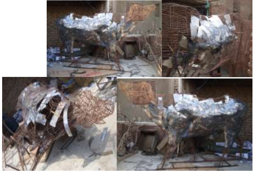
مراحل تكمية المجسم الحديدي بشرائح صاج سمك 0.5 مم. بعد تسييت السماعات داخل الفحل
