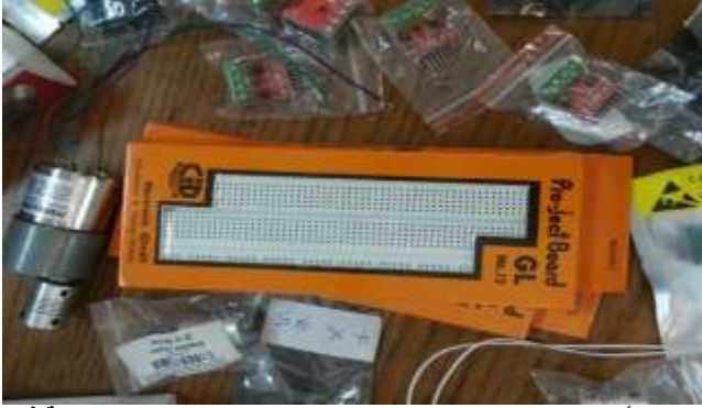
بعض أشكال الواح التوصيل الكهربى للحساسات والمواتير المستخدمة في ورشة الروبوتيك
