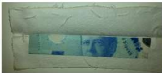
شكل (3) العملتان الورقية والبوليمرية بعد إختبار العرق الحامضي
