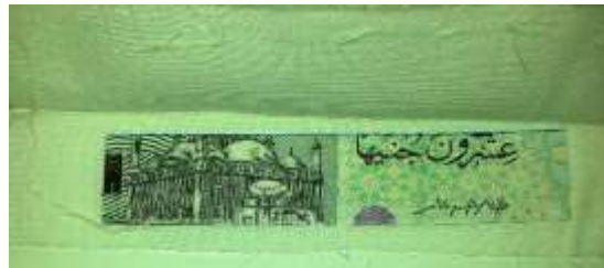
شكل (3) العملتان الورقية والبوليمرية بعد إختبار العرق الحامضي
