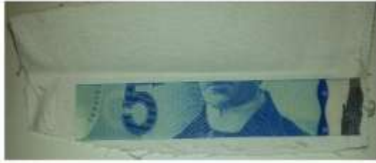
شكل (4) العملات الورقية والبوليميرية بعد اختبار العرق القاعدي
