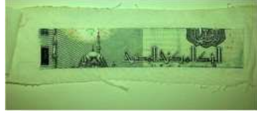
شكل (4) العملات الورقية والبوليميرية بعد اختبار العرق القاعدي
