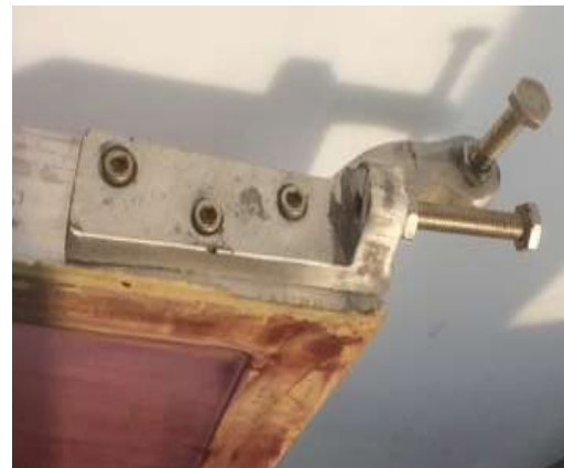
التطبيق السادس: وحدات ضبط الشبلونات على طاولات الطباعة المصدر ( الباحث )
