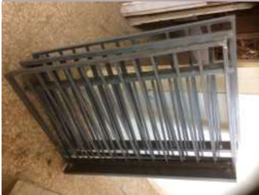
التطبيق الأول : آلة تجفيف وتحميم البولى جيل البيكروماتمن إبتكار وتنفيذ الباحث والمعروفة بإسم المصدر ( الباحث ) Silk Screen Drying Cabinets
