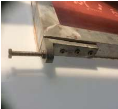
التطبيق السادس: وحدات ضبط الشبلونات على طاولات الطباعة المصدر ( الباحث )
