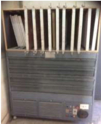
التطبيق الرابع: وحدة التخزين الملحقة بفرن التجفيف للقوالب الطباعية المصدر ( الباحث )
