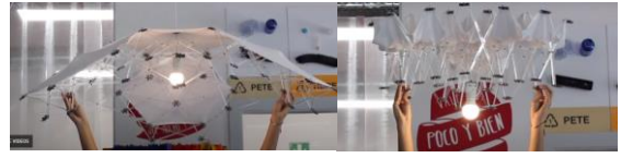
وحدة إضاءة ذات هيكل قابل للتحكم في مقدار الإضاءة
