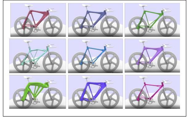
الشكل رقم(8) بدائل حلول لتصميم دراجة من خلال التصميم التوليدي. ( https://www.autodesk.com/solutions/generative-design )
