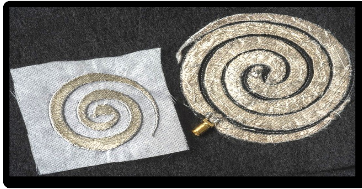
شكل (١٨) هوائي مطرز في القماش باستخدام الخيوط الموصل
