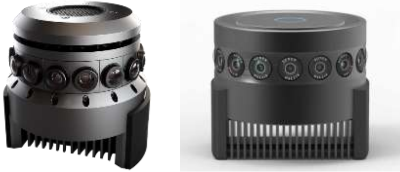
شكل (13) يوضح العدسات المدمجة في Live planet camera
