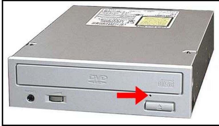
شكل 3: يوضح الثقب الصغير بجهاز الـ CD Rom
