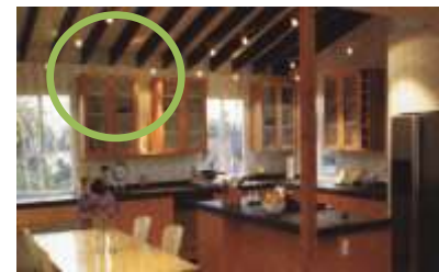
شكل (٢٠) يمكن أيضاً إلغاء تأثير الكمرات الظاهرة الضارة وذلك بوضع مجموعة من وحدات الإضاءة الموضعية (السبوت) Spot
