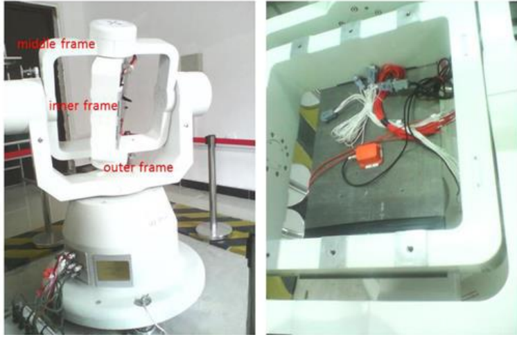
الشكل (9) الطاولة الدوارة لمعايرة الجهاز المصمم.
