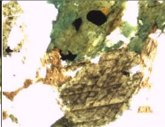
صورة رقم (12) توضح التغير المعدني الجزئي للهورنبلند (اتجاهين للتشقق) الي الكلوريت. (بتكبير X100:PPL).
