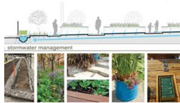
شكل (21) طرق إدارة الأمطار بأسطح الأرض الحصى ، وتدوير المواد
