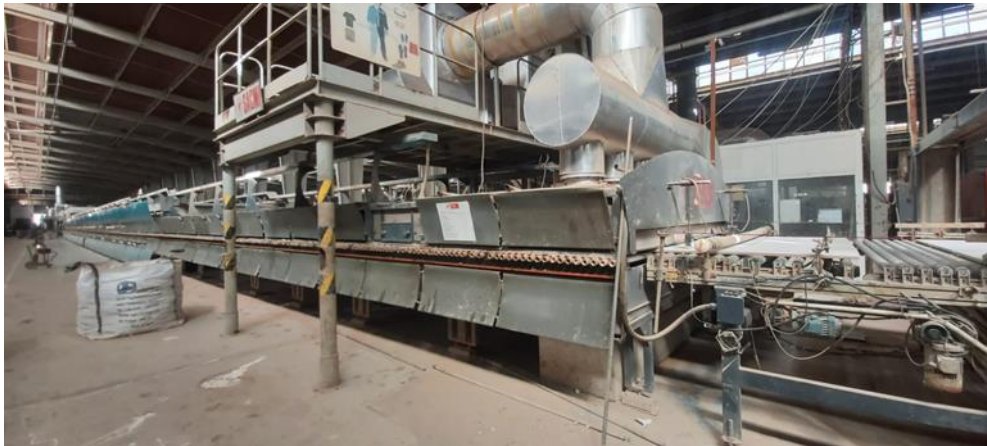
شكل (٢٢) فرن الإنتاج ( الحريق السريع) roller kiln
