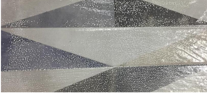
أ. التطبيق برش مستحلب الملح فوق التصميم المطبوع بطريقة الحبر النفثي (Ink Jet)
