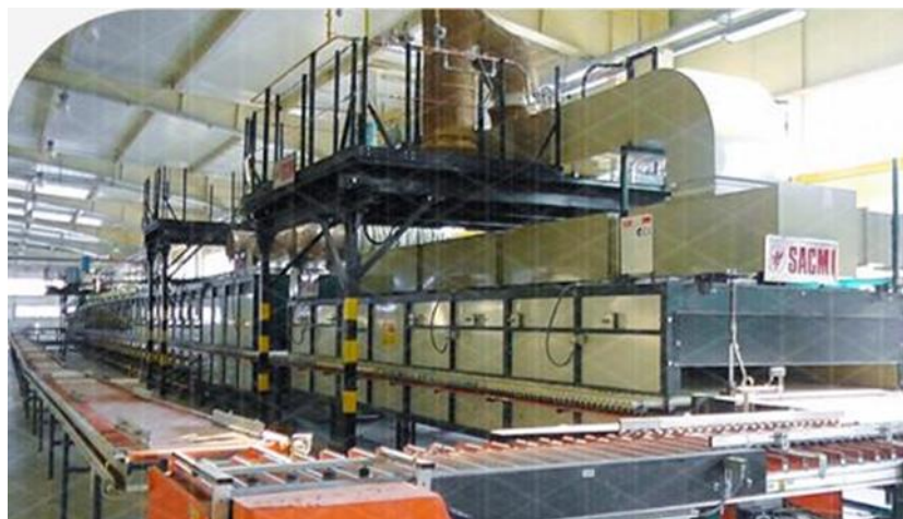
شكل (٢٣) فرن الزخرفة roller kiln
