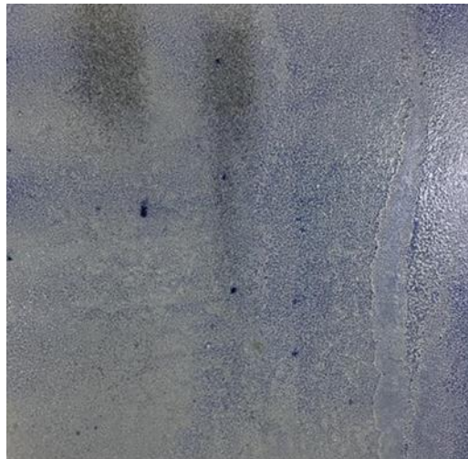
الحريق عند ١١٧٠ ودورة الحريق ٣٨ دقيقة والتطبيق بمستحلب الملح الملون بالرش تجربة (١٦)
