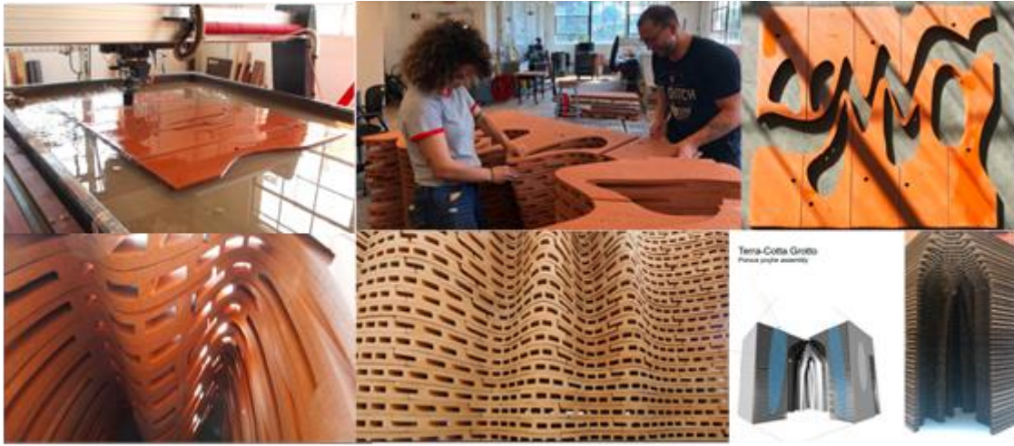
صورة (١١) ورشة (ACAW 2019) التي تنظمها شركة بوسطن فالي تراكوتا بأمريكا، حيث اعتمد التصميم لفريق (Terra-Cotta Team UB) علم القطع بتقنية النفث المائي لبلاطات التراكوتا.
