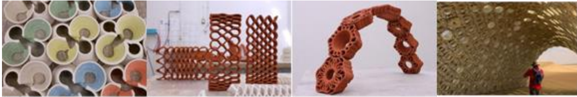
صورة (١٤) نموذج لمشروع تطوير استخدام الخامات المحلية في العمارة التقليدية وباستخدام الطباعة الرقمية وذلك في إبريل ٢٠١٤ حيث تم استخدام الطين في عمل نماذج لوحدات من الطوب والأقواس تستخدم في البناء ومعالجة الواجهات وعمل المظلات باستخدام الطباعة الرقمية
