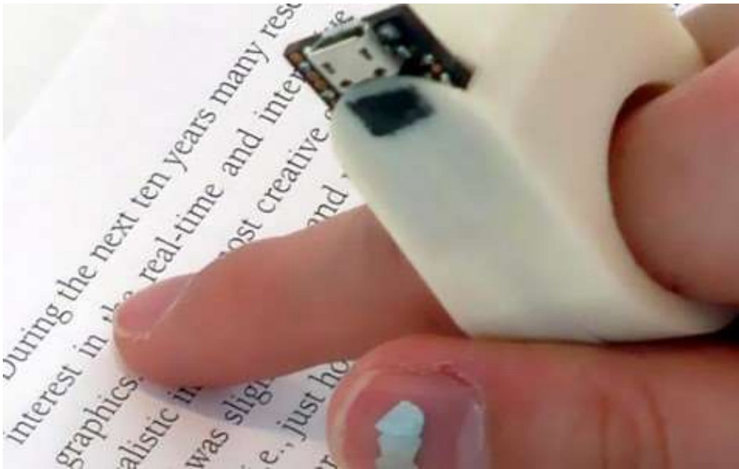
شكل (١) Finger Reader جهاز مزود بكاميرا يقرأ النص للمكفوفين.
