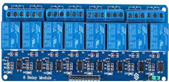
Fig. 22. Relay module.
