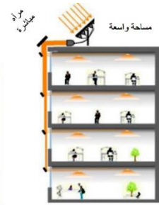
شكل (٣٧) يوضح نظام الحصول علي الإضاءة من الشمس
