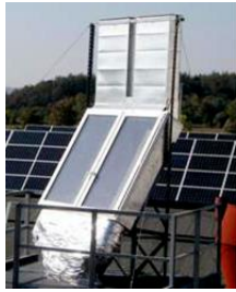
شكل (٣١) يوضح استخدام المدخنة الشمسية في التهوية
