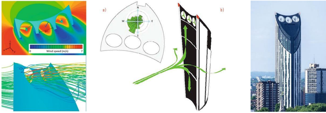
شكل (٧٥) يوضح مبني Strata SE1 بلندن كأحد الأمثلة المميزة لإستخدام طاقة الرياح في توليد الطاقة بالمبني و توضح الصور الشكل العام للمبني و حركة و سرعة الرياح علي المبني بارتفاع ١٤٧ م و هذا المبني للمصمم المعماري BFLS و شكل (٧٦) يوضح أحد المباني المستخدم فيها طاقة الرياح مبني التجارة العالمي بالبحرين في توليد الكهرباء
