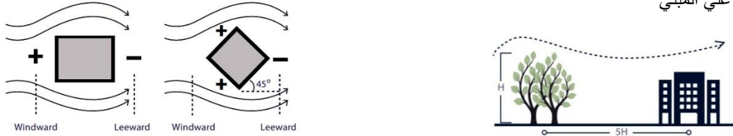
شكل(١٥) يوضح المسافة القياسية لوضع الاشجار امام المبني كمصدات شكل (١٦) يوضح مناطق الضغط المرتفع و المنخفض
