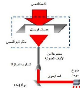
شكل (٣٦) نظام الواح بارنز للإضاءة الشمس
