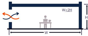
شكل(١٨) تأثير ارتفاع النوافذ علي الفراغ الداخلي
