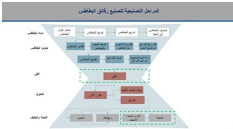
شكل (١) يوضح تسلسل العمليات التصنيعية لخط إنتاج رقائق البطاطس. المصدر: اعداد الباحث للمصنع محل الدراسة.
