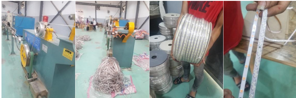
صور (٥-٨) توضح ماكينة تصنيع سلك الليد الكهربائى
