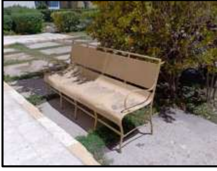
(شكل ١٩) وحدة المقاعد الخارجية مصنوعة من الحديد تكون شديدة السخونة تحت الشمس وشديدة البرودة وقت البرد فضلاً عن كونها تحتفظ بالمياه علي سطحها في حالة المطر .
