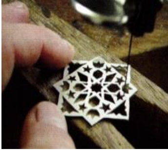
شكل رقم (٧) يوضح طريقة تفرغ قطعة المعدن
