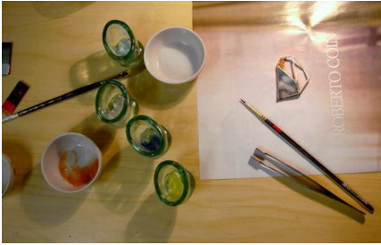
شكل رقم (١٦) يوضح تعبئة المينا في الفراغات باستخدام فرش طلاء
