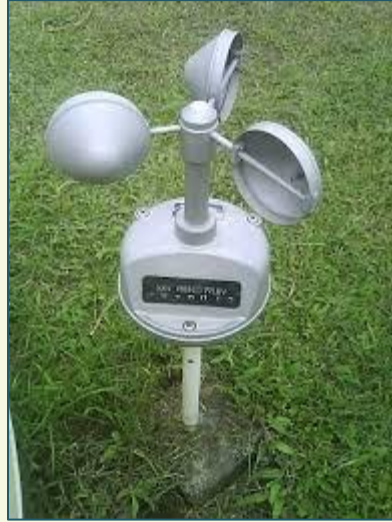
شكل (٥-٢): مقياس سرعة الرياح بمحطة الأرصاد الجوية
