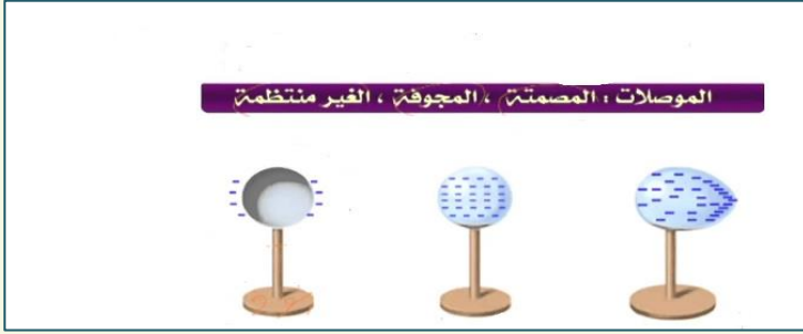
شكل (٤-٦): توزيع الشحنة الكهربائية على أسطح الأجسام غير المنتظمة
