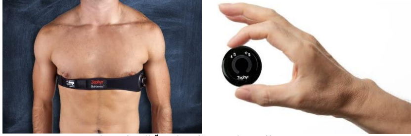
شكل (٧) - جهاز Bio Harness 3 لقياس البيانات الفسيولوجية للسانقين والرياضيين. (٢٠)
