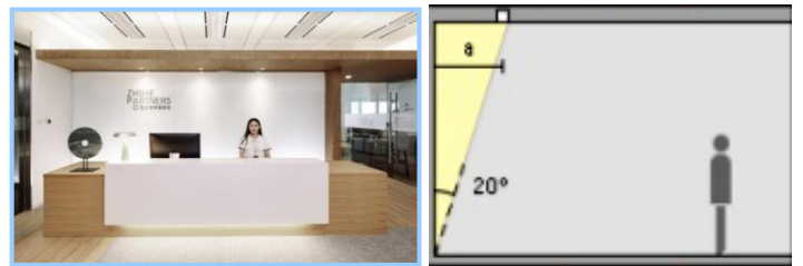
(شكل 10) يوضح القاعدة الأساسية لترتيب الإضاءة المائلة للجدران لتسليط الضوء على المواد المستخدمة لنهو الحوائط
